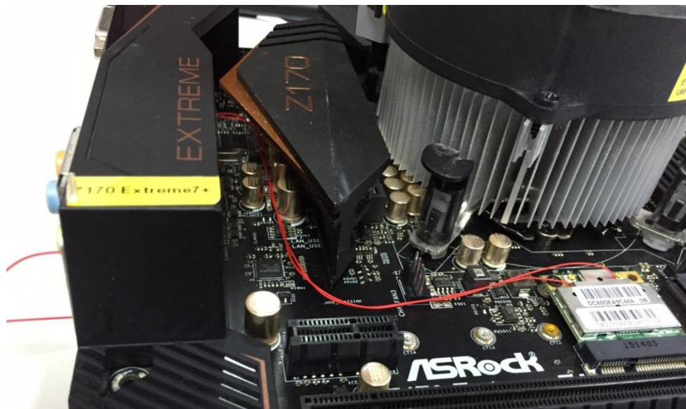
步骤 3 - 如下图所示将 IO 挡板装回 Z170 Extreme7+。
