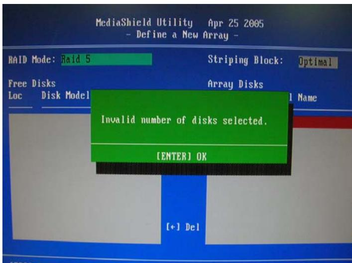
**答：** K8NF4G-SATA2 支持 RAID 0（Striping，分割），RAID 1（Mirroring，镜像）和 JBOD（Spanning，延伸）RAID 模式， 但不支持 RAID 0+1（Stripe Mirroring）和 RAID 5 模式。当您在 MediaShield Utility 程序里将“RAID Mode”（磁盘阵列模式）选项调节为“Stripe Mirroring”（RAID 0+1）或“RAID 5”模式时，系统将会显示错误信息“Invalid number of disks selected”（选择的盘符无效），提示您系统不支持“Stripe Mirroring”和“RAID 5”模式。
